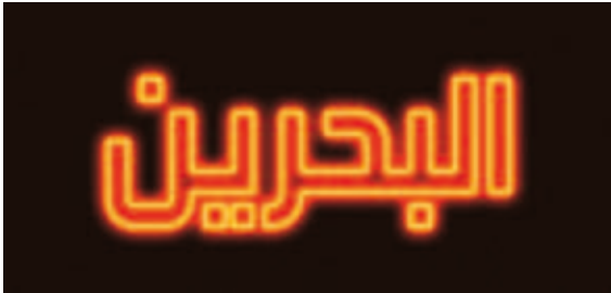
■ الشكل 5-2 تنتج التأثيرات الضوئية الملونة في إشارات النيون عن البلازما المضيئة المتكوّنة في الأنابيب الزجاجية.
