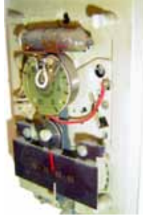
■ الشكل 21-2 في منظم الحرارة (الترموستات) المبين هنا، يتحكم شريط حلزوني الشكل مصنوع من فلزين (مزودج حراري) في تدفق التبريد لفتح الدوائر الكهربائية وإغلاقها..
