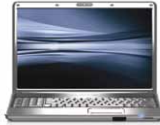
الشكل 2-4 لأن عنصر المغنيسيوم خفيف وقوي يستخدم في تصنيع الأجهزة الإلكترونية. فمثلاً الإطار الخارجي لهذا الحاسب الآلي المحمول مصنوع من المغنيسيوم.
