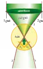
الشكل 1 تثبتي الحزمة الضوئية. في أثناء مرور أشعة الليزر من خلال الخلية، وتبذل هذه الحزمة قوة صغيرة على الخلية تعمل في الاتجاه المعاكس، وتثبت هذه القوة الخلية في مكانها.
