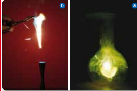
الشكل 4-3 يُنتج كل من هذه التفاعلات الكيميائية طاقة كبيرة في أثناء تكوين المركبات الأيونية a. ينتج عن التفاعل بين عنصري الصوديوم وغاز الكلور بلورات صلبة بيضاء اللون. b. ينتج عن اشتعال شريط فلز الماغنيسيوم في الهواء مركب أيوني يسمى أكسيد الماغنيسيوم.
