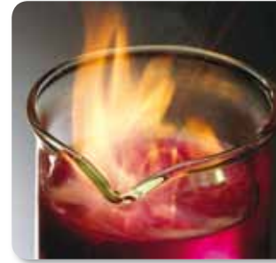
الشكل 5-9 يتفاعل فلز البوتاسيوم بشدة مع الماء مطلقاً كمية كبيرة من الحرارة كافية لإشعال غاز الهيدروجين الناتج وارتفاعه.
